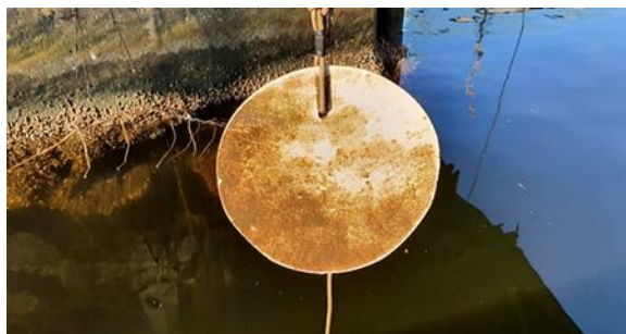
Figura 3: Disco realizzato interamente a Magmite recuperato dopo un tempo di immersione pari a dodici mesi nelle acque del porto di Viareggio.
