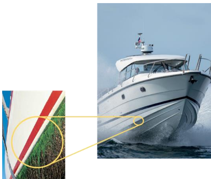
Figura 2: Incrostazioni biologiche (fouling), responsabile di possibili danni allo scafo.
