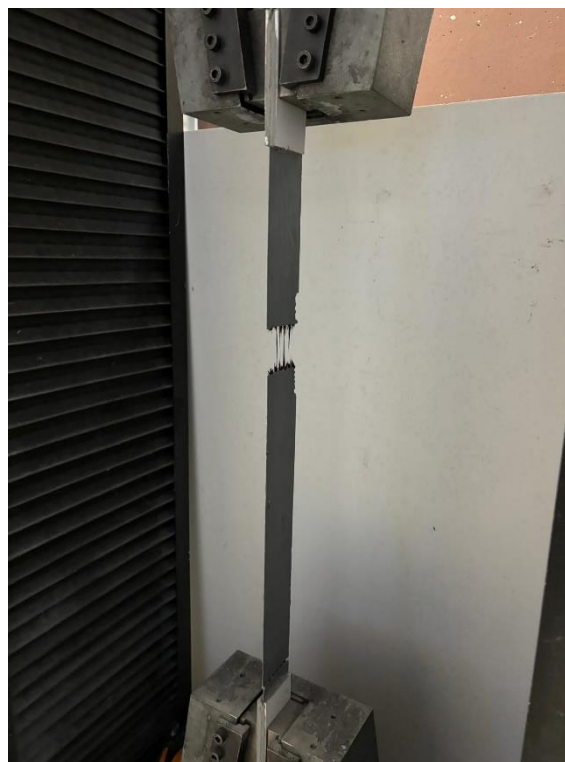
Figura 2: Modalità di rottura di un provino di rete CT570 sabbiata strato dopo la prova di trazione
