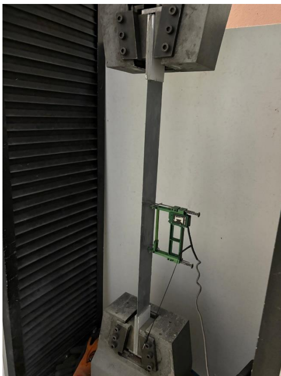
Figura 1: Un provino di rete CT570 sabbiata strato prima della prova di trazione
