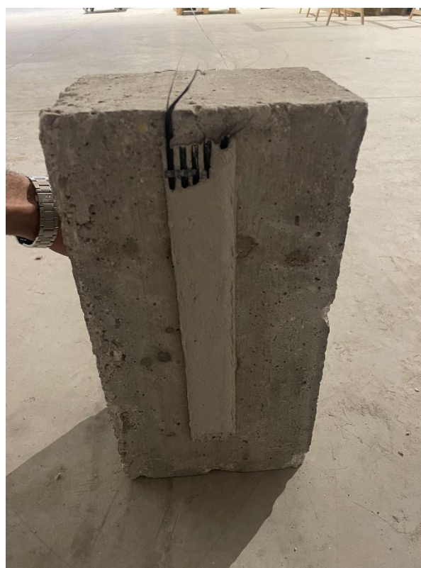
Figura 4: Modalità di rottura di un provino di FRCM_ CT570 sabbbiata in singolo strato dopo la prova di distacco su supporto di calcestruzzo
