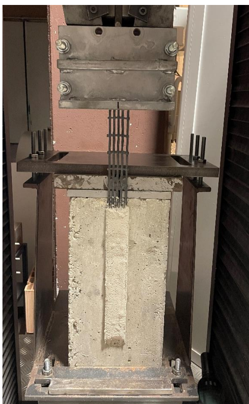
Figura 3: Un provino di FRCM_ CT570 sabbbiata in singolo strato prima della prova di distacco su supporto di calcestruzzo
