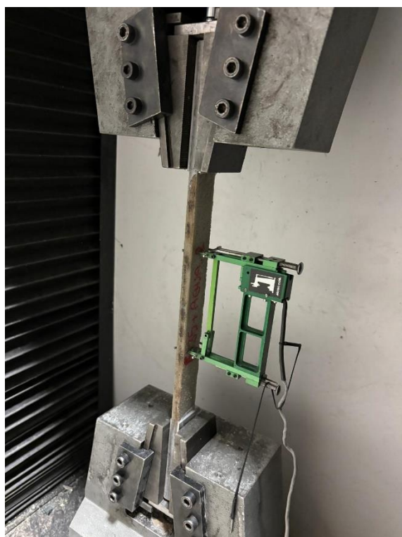
Figura 2: Un provino di GLV1350 + AQUA in triplo strato prima della prova di trazione
