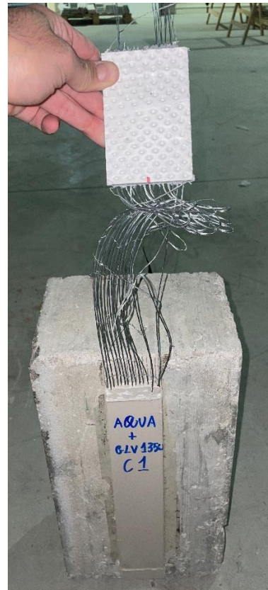
Figura 5: Modalità di rottura di un provino di FRCM_ GLV1350 in singolo strato dopo la prova di distacco su supporto di calcestruzzo
