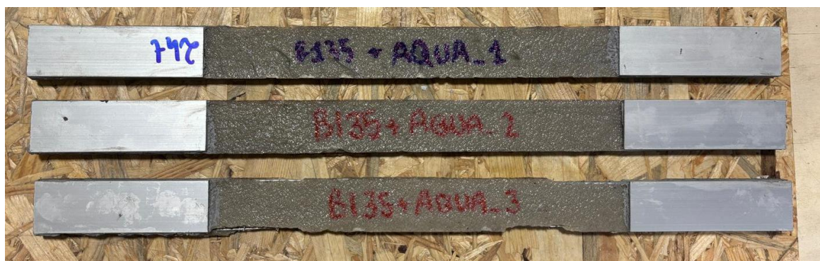
Figura 1: I provini di GLV1350 + AQUA in triplo strato da sottoporre a prove di trazione
