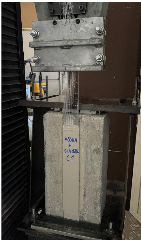
Figura 4: Un provino di FRCM_ GLV1350 in singolo strato prima della prova di distacco su supporto di calcestruzzo
