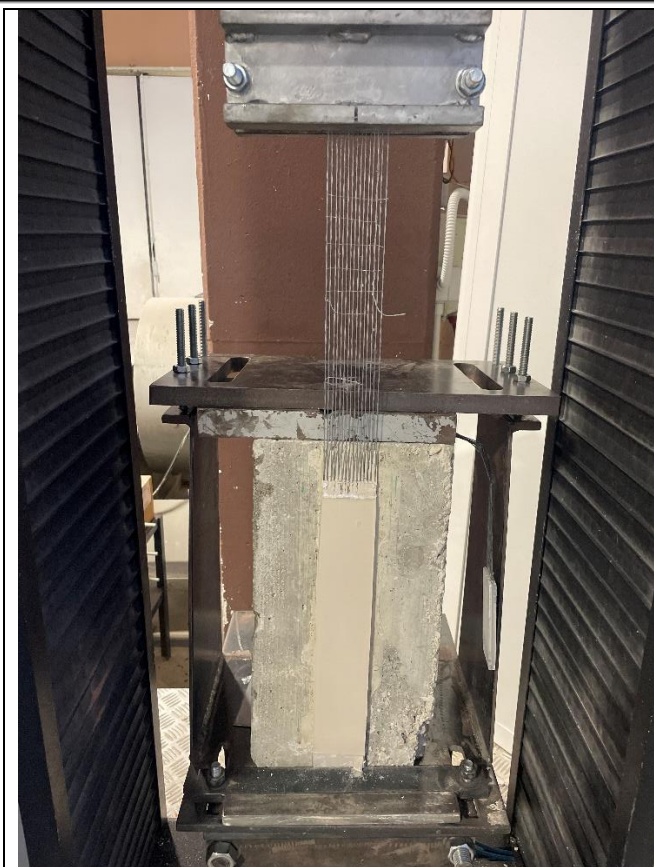
Figura 6: Modalità di rottura di un provino di FRCM_ GLV1350 in singolo strato dopo la prova di distacco su supporto di calcestruzzo
