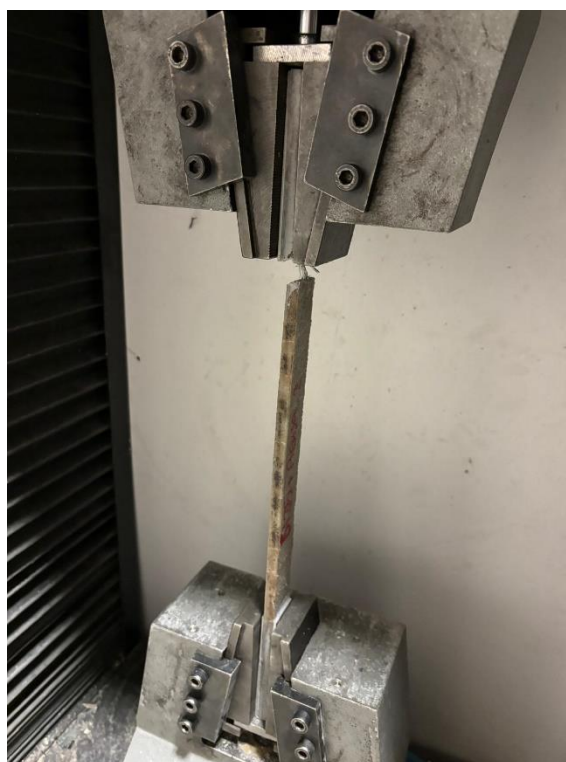
Figura 3: Modalità di rottura di un provino di GLV1350 + AQUA in triplo strato dopo la prova di trazione
